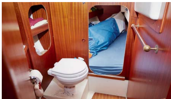
Her er den nyeste Omega 36 version, hvor toilettet er placeret agter og delvis under cockpitet. Her er der gennemgang til styrbord kistebænk, der også kan benyttes som ekstra køje.
