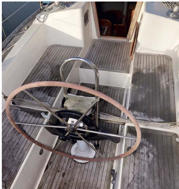
Omega 36 har dejligt stort cockpit med lange kistebænke. Båden er født med rorpind, men "Timberlane" har fået ratstyring med autopilot. De mørke pletter på teaktræet er tynd is.
