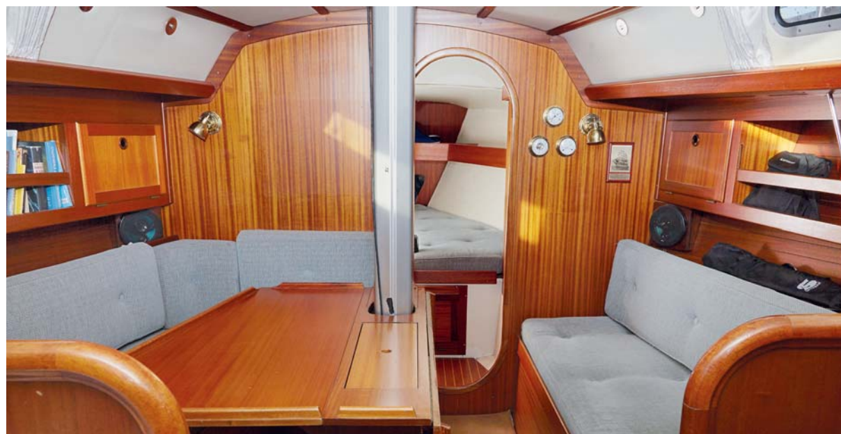
Salonen er rummelig og traditionel med et stort klappbord og god gennemgang til forkahytten. Der er gode søsikre hylder og skabe i borde. Til styrbord ses stålroden til røstjernet, der er trukket helt ind til ruffet.
