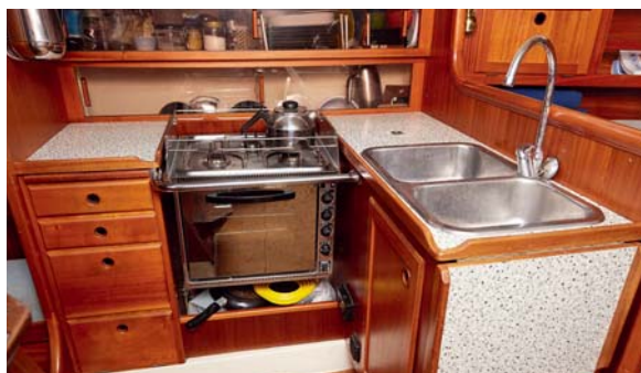
Pantryet er stort og moderne for den tids både. Her med nyere SMEV gaskomfur. Bemærk stålbøjlen omkring komfuret og det praktiske klappbord ved siden af vasken. Skufferne er med massive forsider.
